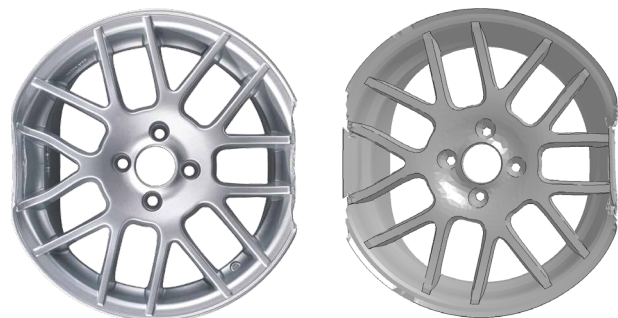
2 Vergleich der Felge nach dem Crash: Versuch (links), Simulation (rechts).
