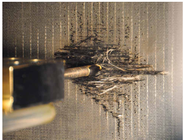
2 Detailansicht des Schädigungsbilds eines ungeschützten CFK-Panels nach einem 100-Kiloampere-Blitzschlag.
