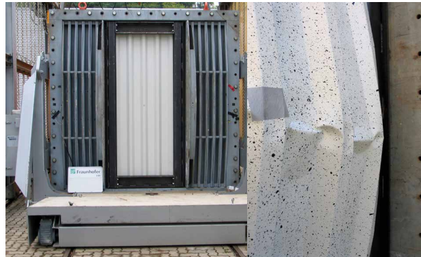
1 Versuchsaufbau am Stoßrohr (links) und beobachtetes lokales Beulen am gesprenkelten Blech (rechts).
